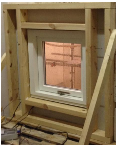
Billede 2. Indvendig side af vindues-konstruktion – normale indendørs forhold.
